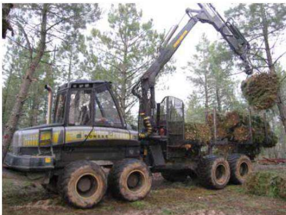
Fig. Autocargador Ponsse transportando pacas.
