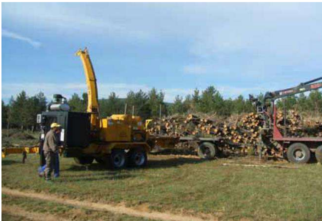
Fig. Astilladora de cuchillas de tambor Woodsman.
